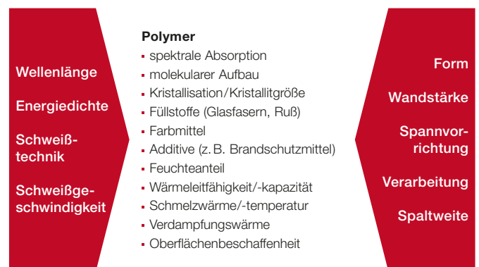
Abb. 3: Einflussfaktoren auf die Eindringtiefe der Laserstrahlung in den Kunststoff und die Schweißnahtqualität
